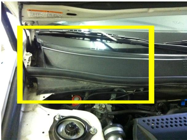
Der Innenraumfilter befindet sich auf der Beifahrerseite hinter der Abdeckung der Frontscheibe.
