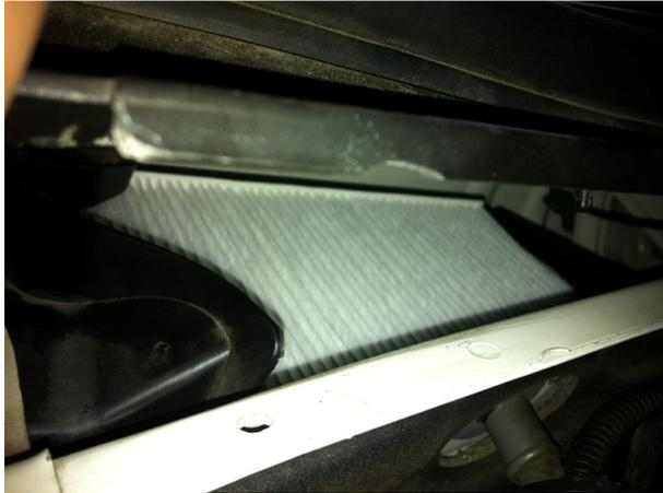
Jetzt kann man die Abdeckung etwas anheben und man kann den Innenraumfilter sehen und herausnehmen. Beim Einbau auf die Pfeile am Filter achten. Diese müssen beim Einbau nach unten zeigen. Dann die Abdeckung wieder drauf und den Kunststoffnippel wieder rein.
