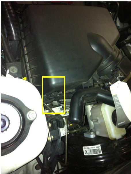
die eine Spange hinten am Luftfilterkasten.
