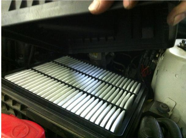
Nun kann der Luftfilterkasten geöffnet werden und der Luftfilter herausgenommen werden. Den neuen Filter einsetzen und den Deckel aufsetzen. Dann den Deckel mit den 4 Spangen befestigen.
