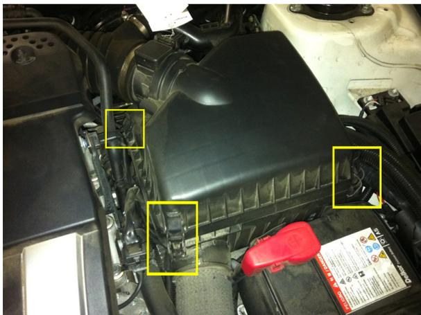
Der Luftfilterkasten befindet sich im Motorraum auf der rechten Seite. Um an den Luftfilter zu gelangen, müssen die 3 Spangen gelöst werden und ...
